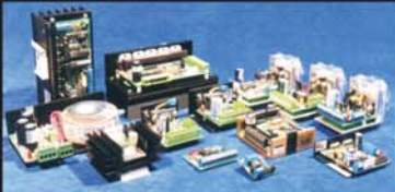
Sterowniki silników krokowych kontrola ruchu, choppery z mikrokontrolerem
