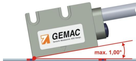
Rys. 3. Maksymalny dozwolony kąt nachylenia
